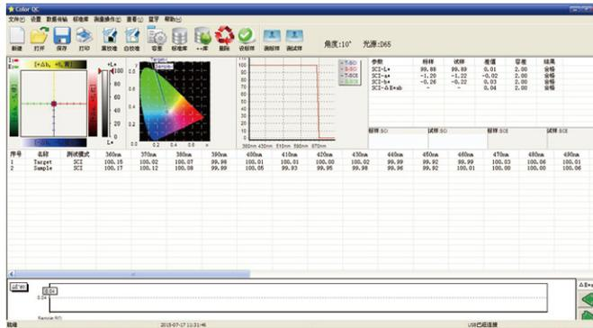
标样测试完后取出标样,将试样放入测试架,并点击颜色管理软件中的测试样进行测试,得出试样的测试数据,可进行对比,并且可将测试数据进行打印输出。
