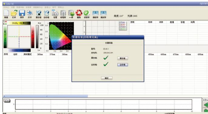
黑校准完成后,取下黑校正板,点击窗口弹出框的白校准按钮进行白校准。
