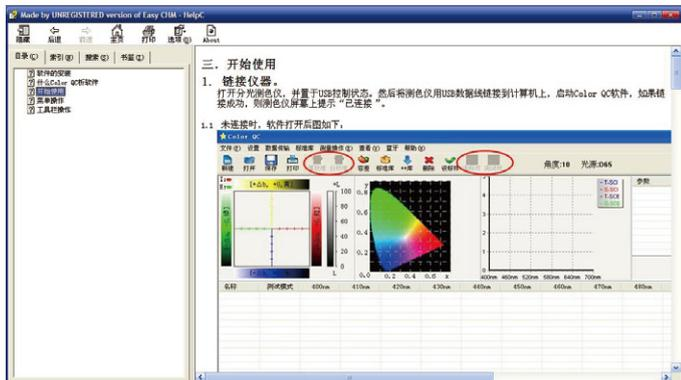
点击左边栏开始使用模块可看到软件的使用方法，仪器未连接到电脑时，黑白校准和测标样、测试样工具呈现无法选择状态。
