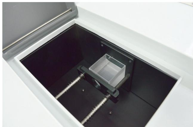
白校准完成后,将样品放入测试架,如上图。点击测标样进行标样测试,如下图。
