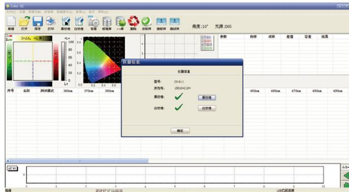
当仪器和电脑连接成功时，将黑校正板放置于测试架，并盖上测试室盖子，点击工具栏“黑校准”按钮，对仪器进行校准。
